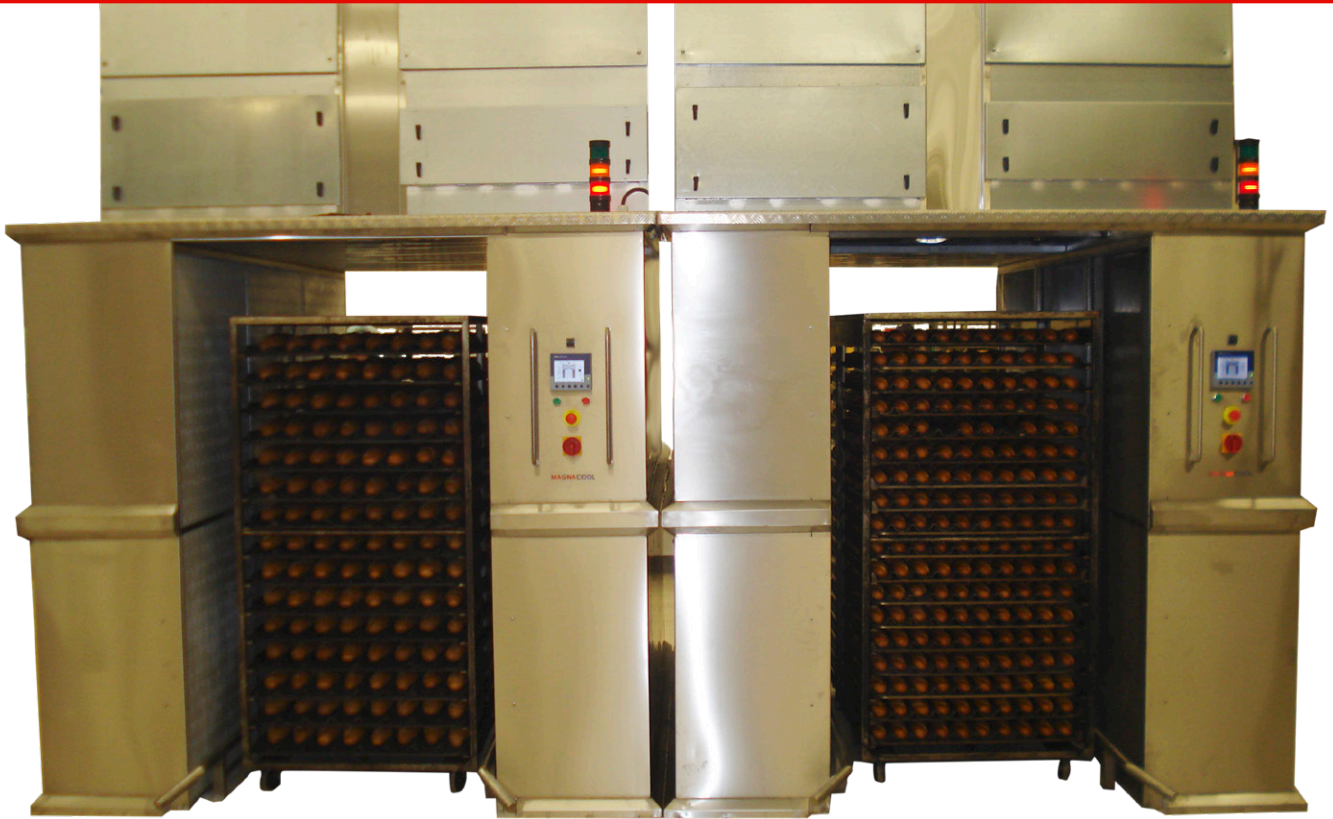
Deux refroidisseurs de boulangerie (côte à côte)
